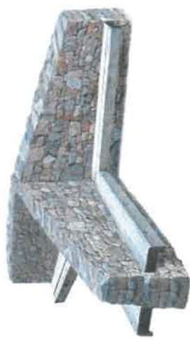
BANCS, toujours un côté à l'abri du vent. Mur en pierre sèche ou maçonnerie selon contexte, banquettes bois.
